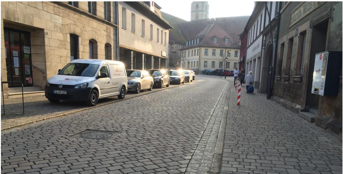
Beispiel Langenzenn Fahrbahn gepflastert, Gehweg gepflastert mit Bordstein (Foto D. Rupsch)
